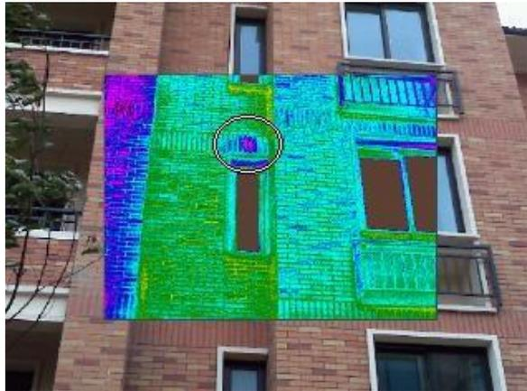
脚手架钢管拆除后没有及时修补就铺设外墙砖，这些缺陷点极易引起渗漏
